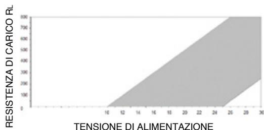
Nel diagramma riportato è rappresentato il rapporto ottimale tra il carico e l'alimentazione per trasmettitori con uscita 4...20mA. Per il corretto funzionamento si utilizzi una combinazione di resistenza di carico e tensione di alimentazione tali da rimanere entro la zona ombreggiata.
