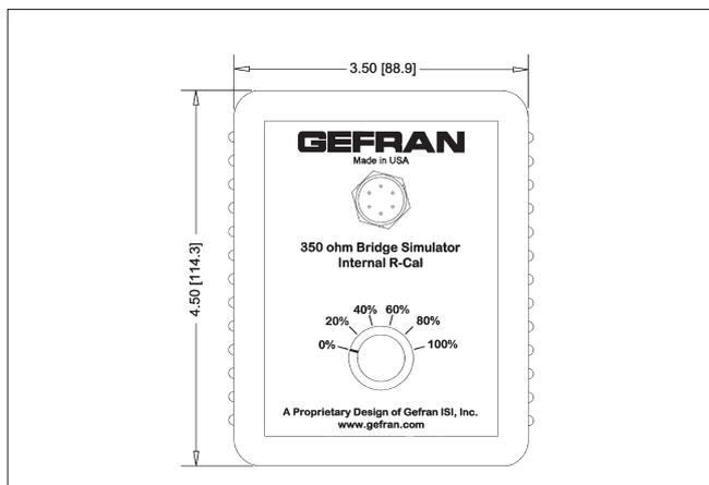
Il TS3 simula l'uscita di un trasduttore di pressione di melt mV/V Gefran (serie M3 e W3) a vari livelli di pressione.
