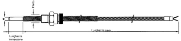
TR5 V: con raccordo di connessione a vite
