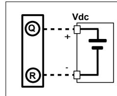
(\*) : Nota: per installazioni UL il dispositivo deve essere alimentato da una unità di alimentazione con classificazione NEC classe 2 o SELV
