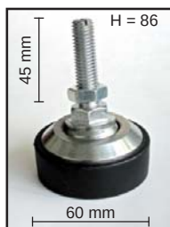
PIEDINOSB2ZNC M12X1.75 IN ACCIAIO ZINCATO NICKEL-PLATED FOOT
