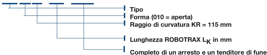
ROBOTRAX R 100, Forma 010 (aperta), Raggio di curvatura KR 195 mm, Lunghezza 1000 mm
