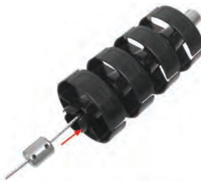
Applicare l'arresto. Inserire la fune d'acciaio nell'arresto, metterla in tensione e fissarla con le viti
