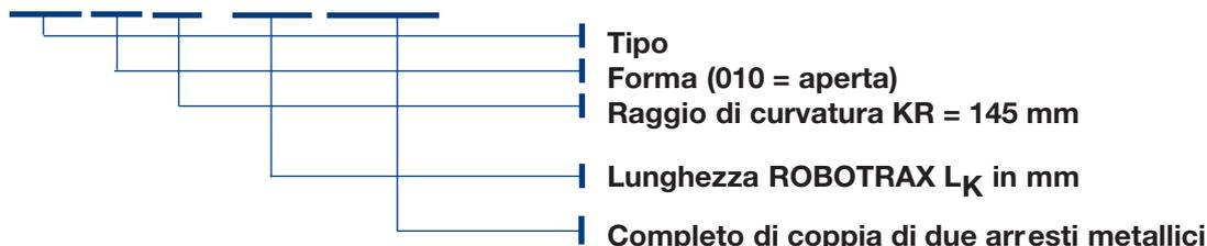
ROBOTRAX R 056, Forma 010 (aperta), Raggio di curvatura KR 115 mm, Lunghezza 1280 mm
